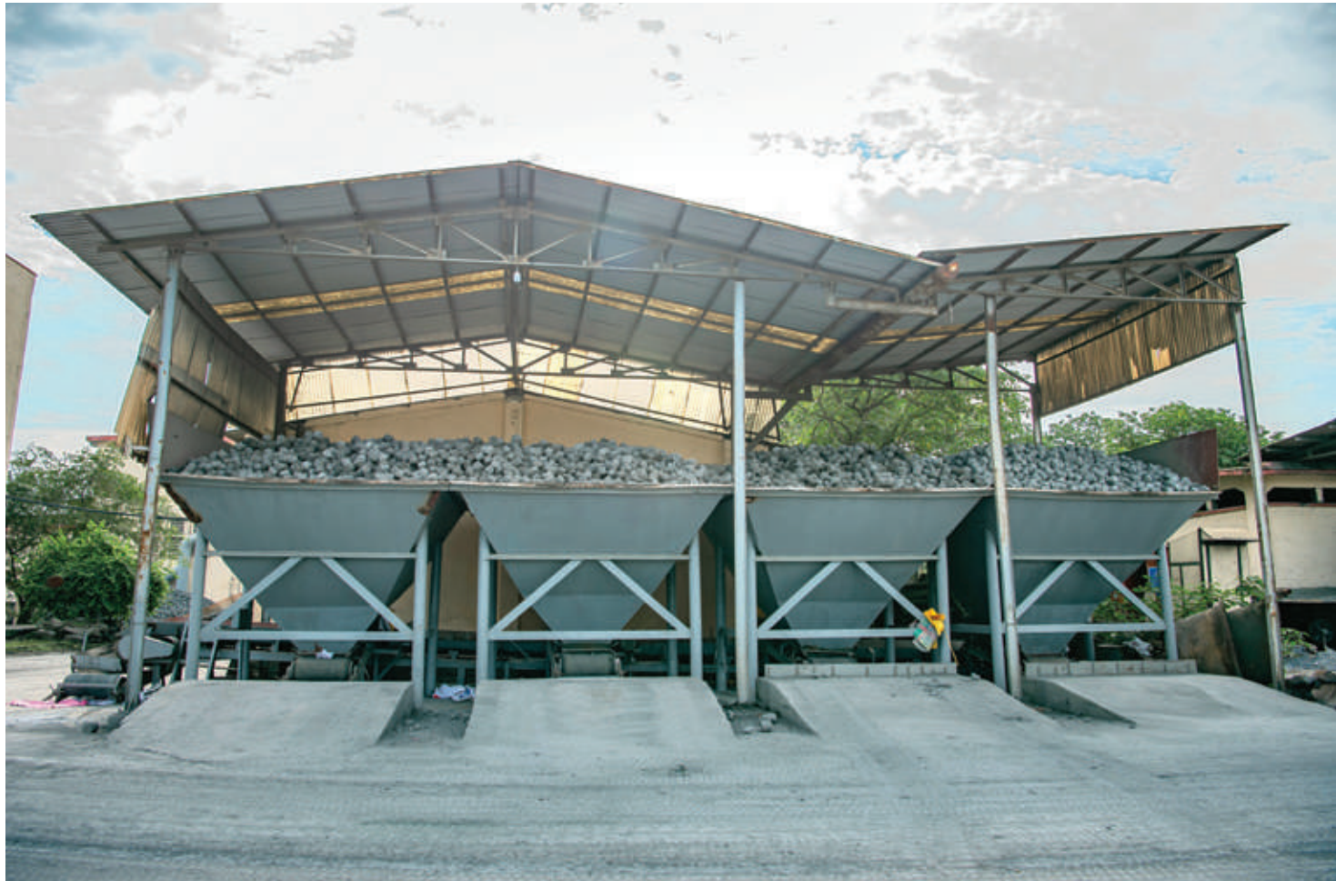
Hệ thống phễu cung cấp quặng bánh cho lò cao thay thế lao động thủ công.
